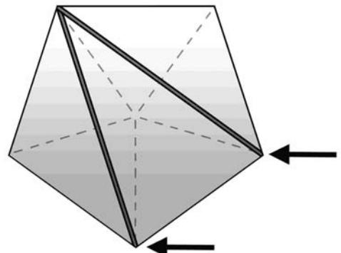
**D** Stellen Sie sicher, dass die beiden Bodenabspannbänder mit dem Kunststoffkarabiner in den entsprechenden Bodenringen eingehängt sind (1).
