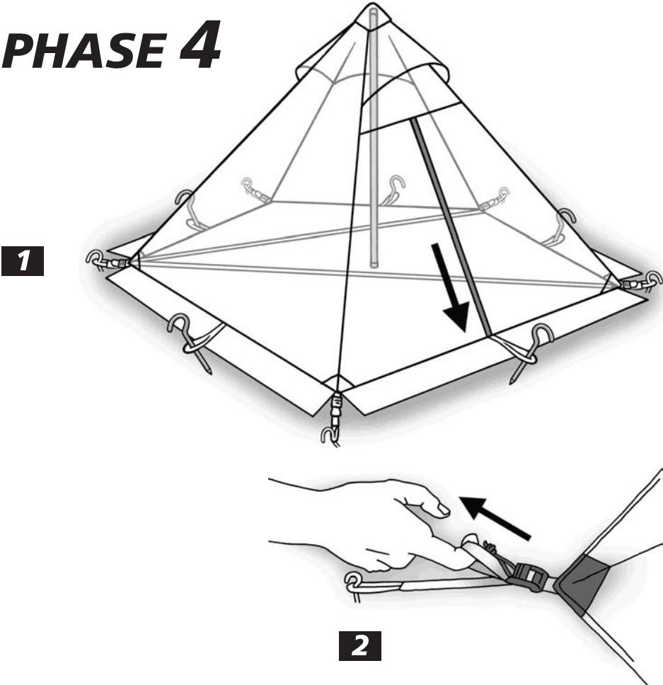
**D** Zum finalen Abspinnen (1) schließen Sie wieder den Reißverschluss des Zeltzugangs und spannen sie die fünf Bodeneckbänder straff ab (2). Spannen Sie nachfolgend alle elastischen Schlaufen der Seitenmitten und am Eingang mit Heringen ab (3). Mit Hilfe der dafür vorgesehenen Abspinnleinen und der restlichen Heringe können Sie Ihr Zelt sturmstabil fixieren (4).
