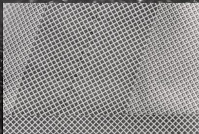
**2,5 LAGEN** Oberstoff und Beschichtung/Membran fest verbunden. Aufgedruckte Schicht schützt die Membran, zusätzliches Futter überflüssig.
