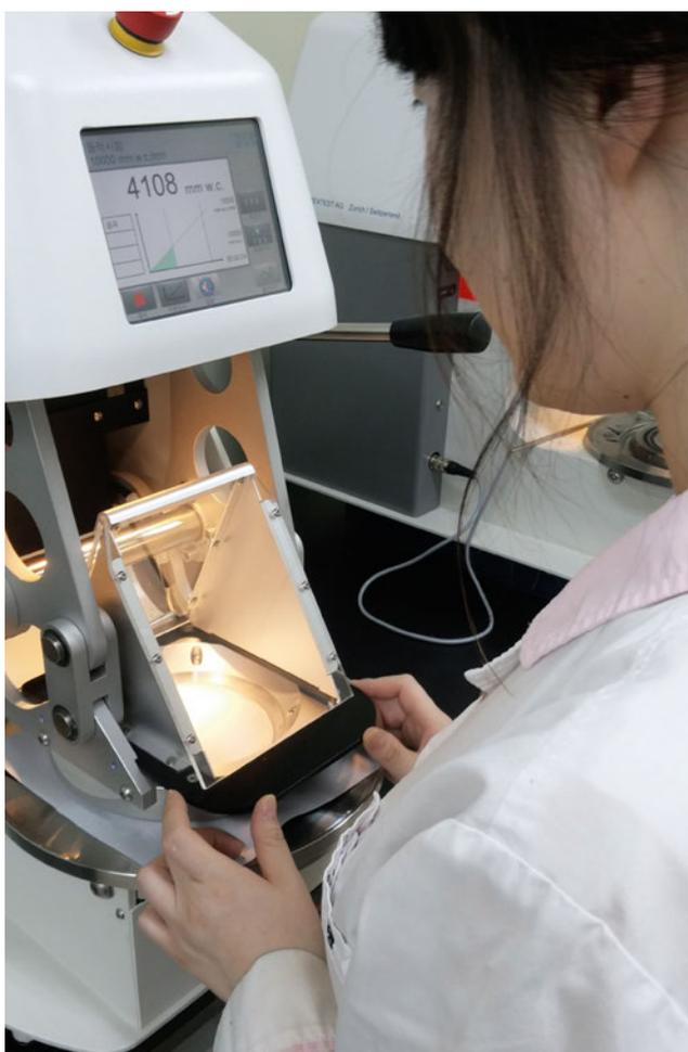
Im Hydrostatic-Tester überprüfen wir die Wasserdichtigkeit und ermitteln die maximale Wassersäule, die das Material aushält.
