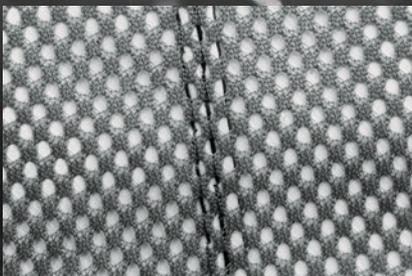
**2 LAGEN** Feste Verbindung aus Oberstoff und Beschichtung/Membran, Kombination mit losen Futterstoffen zum Schutz der Wetterschutzschicht.
